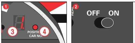
Při zobrazení adresy vozidla se na segmentovém displeji navíc zobrazuje bod vpravo dole, obr. ①. Zapněte řídící jednotku Control Unit, obr. ②; asi na 3 sekundy se zobrazí aktuální nastavená adresa vozidla ③. Adresu vozidla je možné stisknutím ovládacího tlačítka ④ přepnout na jinou adresu. Tiskněte tlačítko ④ opakováne, dokud se nezobrazí požadovaná adresa ③. Po 3 sekundách segmentový displej ③ přepne znova na zobrazení pozicev závodech.
