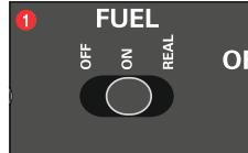
Když je na řídící jednotce Control Unit zapnuta tankovací funkce, obr. ①, slouží displej řidiče Driver Display ve spojení s Pit Lane jako informační zobrazení stavu hladiny v palivové nádrži ① a počtu tankování ②. Blikáním resp. svícením pět žlutých LED diod ② zobrazí maximálně 10 tankování. (Každá LED počítá 2 tankování.) Sloupcové zobrazení LED diodami ① ukazuje aktuální stav naplnění palivové nádrže.
